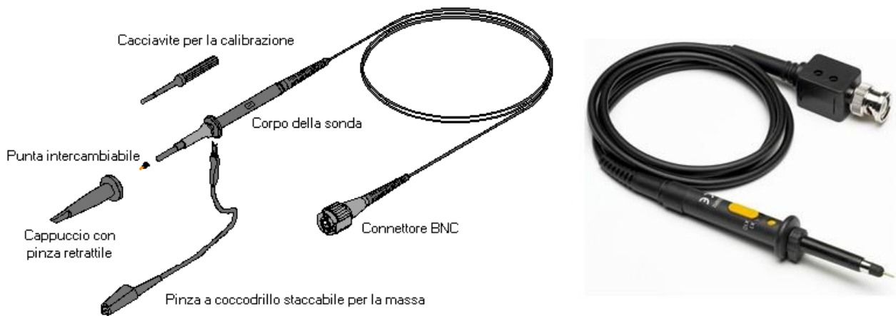
Fig. 7 – Schema rappresentativo e foto di una comune sonda per oscilloscopio
