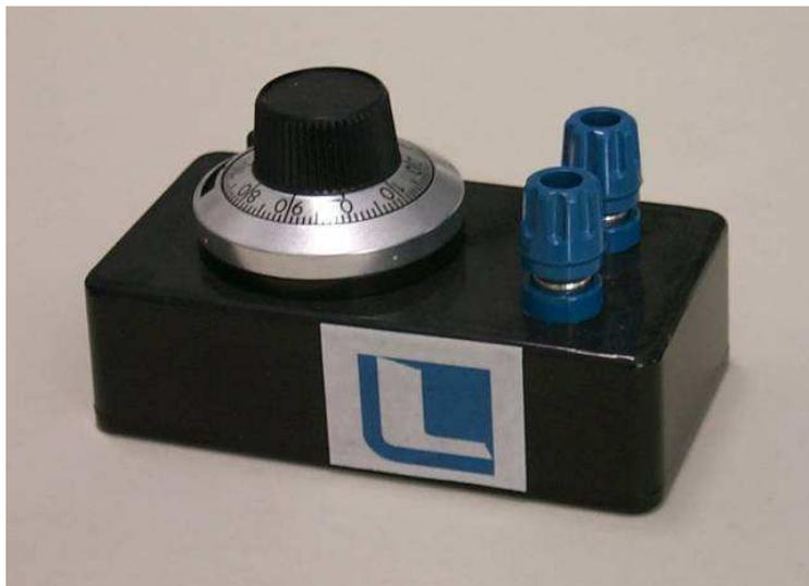
Figura 4: Potenziometro multigiri da 1 k $\Omega$ .
