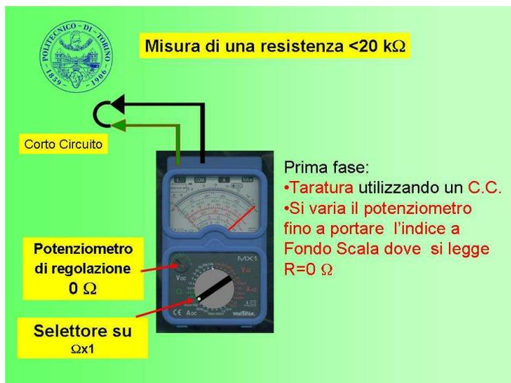
Figura 9: Collegamenti del tester Metrix per effettuare misure di resistenze.
