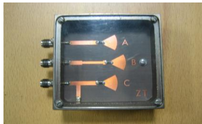
Fig. 2 a) Carico da 100 \Omega . b) Adattatore a \lambda/4 . c) Adattatore ad L.
