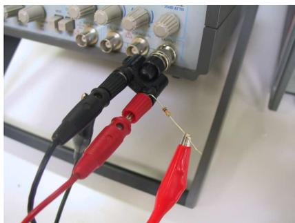
Figura 2: Collegamento del generatore di funzioni con una resistenza in serie da 1 kΩ per mezzo della transizione BNC-banana.
